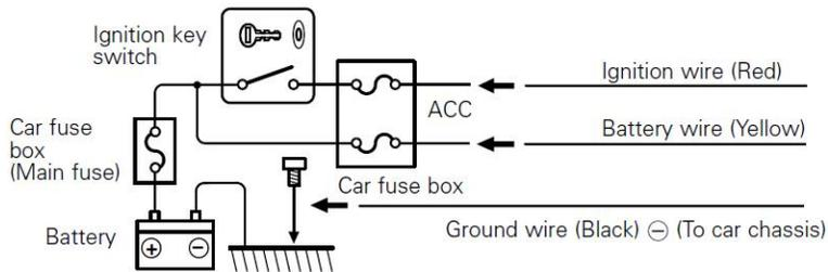
**\*\*NOTE: THE RADIO'S YELLOW BATTERY +12V WIRE MUST BE CONNECTED FOR OPERATION.**
